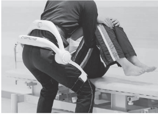
図2：装着型介護ロボット HAL ® 左右の股部（丸い部分）にモーターが内臓されている。腰部の表面電極からの筋収縮の情報が腰部のコントロールユニットで解析され、股部のモーターの動きを制御している。バッテリー駆動で総量が約2.9キロである。
